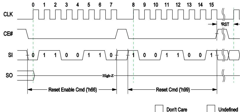
**Figure 17: SPI Reset**
